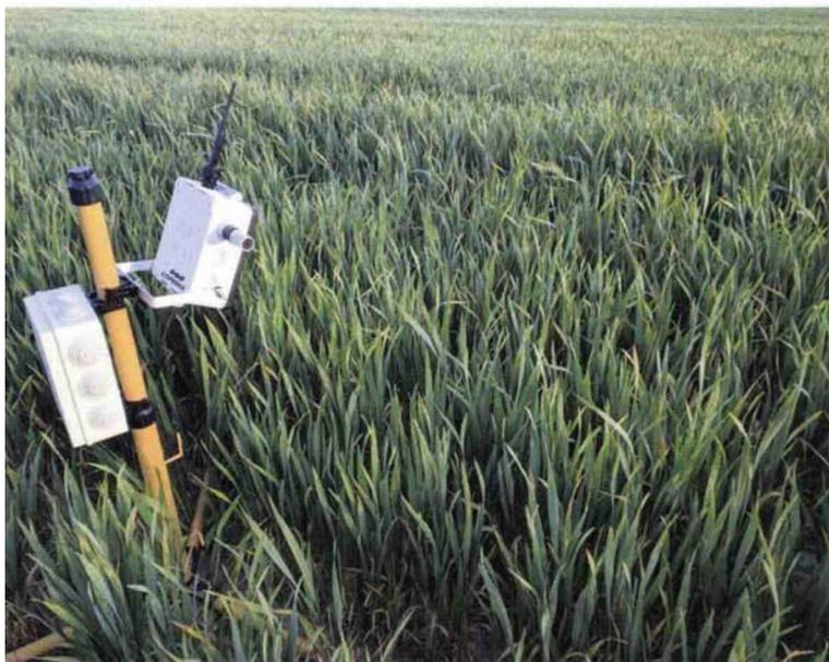
Copeeks a développé un boîtier connecté associant collecte des données issues des capteurs et prises de vues. La start-up bretonne a choisi la technologie LoRa.
